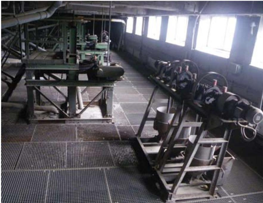
**Abb. 9.8.b: Plungerpumpe und Krählerwerksantrieb auf der Pumpenbühne, Foto 2012**
