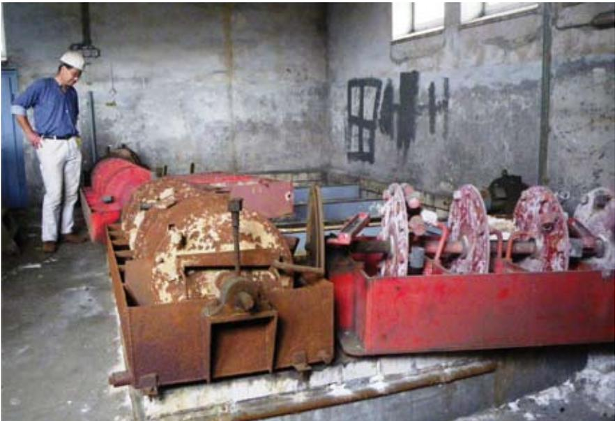
Abb. 9.6.b: Becherschöpfwerk-Dosierer, im Bild Stefan Dützer, Foto 2012
