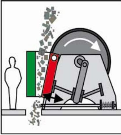
**Abb. 5.1.b: Backenbrecher, Prinzipskizze**
