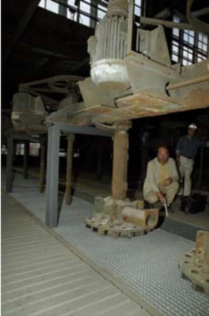
unberücksichtigt. Später wurden Fragmente der demontierten und bereits ausgebauten Flotationszellen geborgen und wieder eingebaut.
