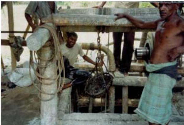
Abbildung 6.1.b: Förderkorb am Schachtförderhaspel, Sri Lanka (Foto Silke Eichhorn 2009)
