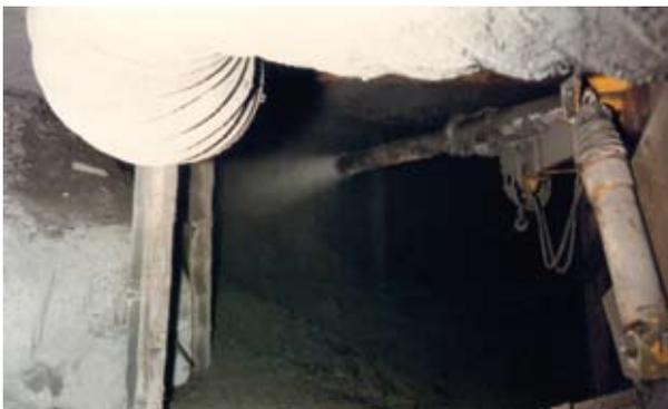
**Abbildung 8.4.4.d: Öffnung des Blasversatzrohrs mit Blasstrahl, 1987 /Sammlung Heinrich Stöcker/**
