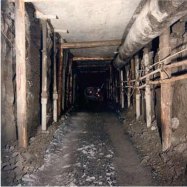
**Abbildung 8.6.3.c:** Foto Ausbau mit Hydraulik- und Holztürstöcken im Wechsel im Querbauartigen Abbau der Kammerpfeiler /Sammlung Heinrich Stöcker/
