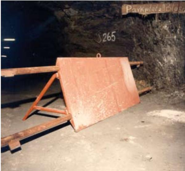
**Abbildung 8.4.4.c: Schild als Vorrichtung zum steileren Blasversatzeinbringen**
