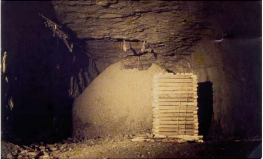
Abbildung 8.4.3.a: Schräppversatz , im Vordergrund ein Erzrollloch, das für die Erhöhung der Versatzsohle vorbereitet ist /Sammlung Heinrich Stöcker/
