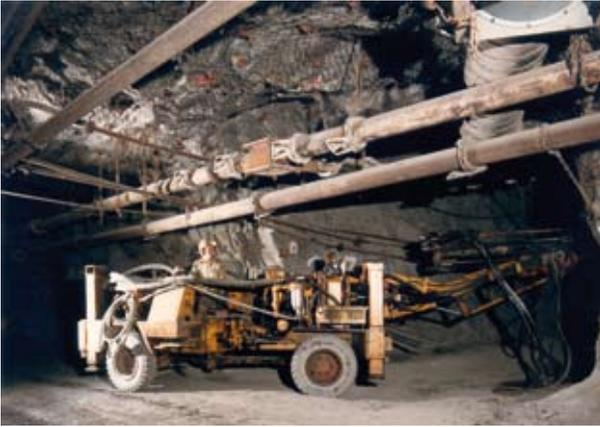
**Abbildung 5.3.p:** Paus-Bohrwagen mit Atlas-Copco-Bohrarm und Tamrock-Bohrhammer /Sammlung Heinrich Stöcker/
