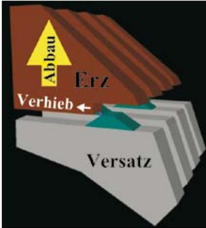
**Abbildung 3.2.a:** Querschlägige Verhiebsrichtung und aufwärts geführte Abbaurichtung beim Kammerbau
