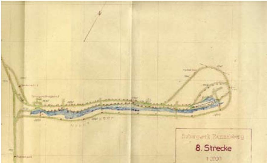
**Abbildung 4.4.3.e: Sohlenriss Fließbau mit vielen Rolllöchern für den Fließbau (braun); lindgrün: Strecken auf der 8. Sohle; blau: Neues Lager**
