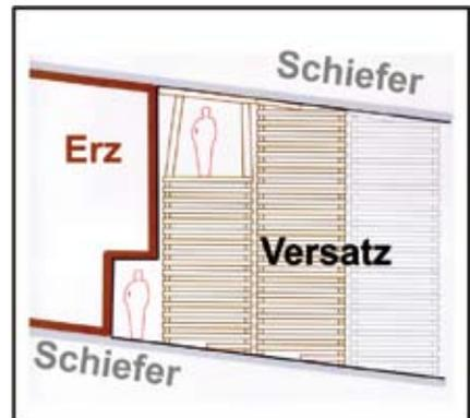
**Abbildung 4.5.d: Prinzipschnitt Stoßbau, Schranken mit Abstand zum Abbaustoß. Die Schranken wurden etwas schräger gestellt, als hier dargestellt.**
