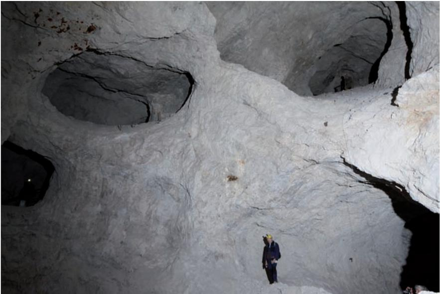
**Abb. 3.2.12.b:** Abbauhohlraum mit Sicherheitsfeste. Blei-Zinkerzgrube Moring in Mezica, Slowenien. Im Bild Thomas Klug (links), Lutz Reuter (oben) und Volkmar Scholz (rechts-unten). Foto Holger Lausch 2014
