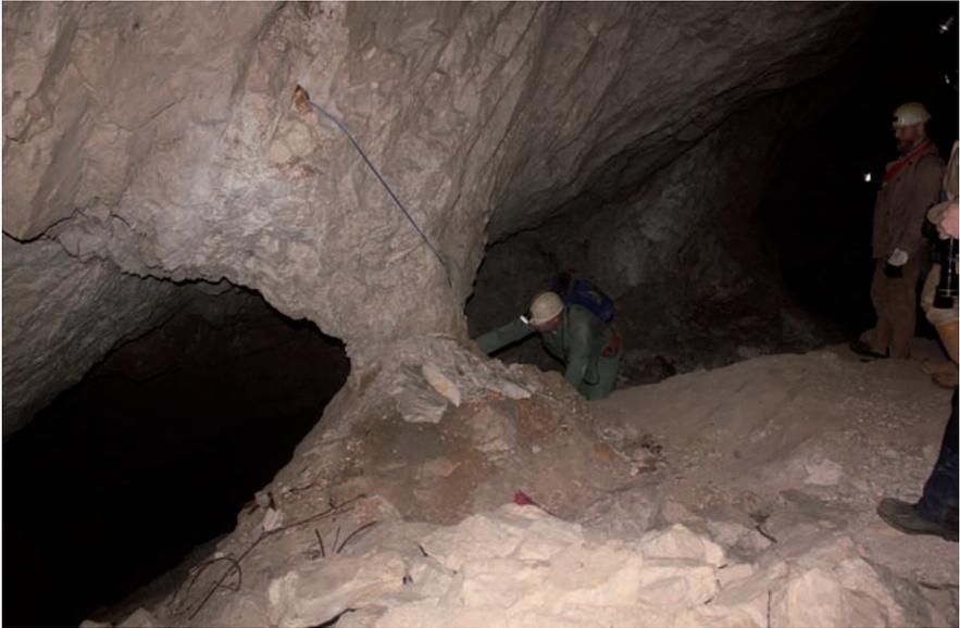
**Abb. 3.2.12.a:** Abbauhohlräume mit Sicherheitsfesten. Blei-Zinkerzgrube Moring in Mezica, Slowenien. Im Bild Thomas Liebisch (links) und der Verfasser (rechts). Foto Holger Lausch 2014
