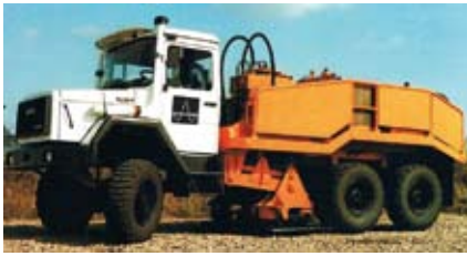
Abbildung 6.7.e: Vibratorfahrzeug VVEA der Prakla-Seismos, Foto aus einem Firmenprospekt der Prakla-Seismos
