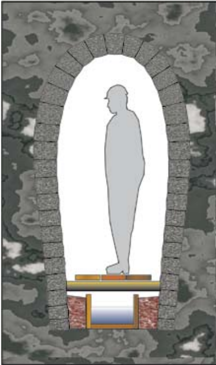
Abb. 4.2.2.b: Skizze Tretwerk und Gerinne in einem Wasserlauf
