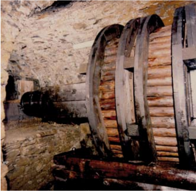
Abb. 4.4.3.b: Seilkorb des Serenissimum Kehrrads, Foto aus der Sammlung Heinrich Stöcker
