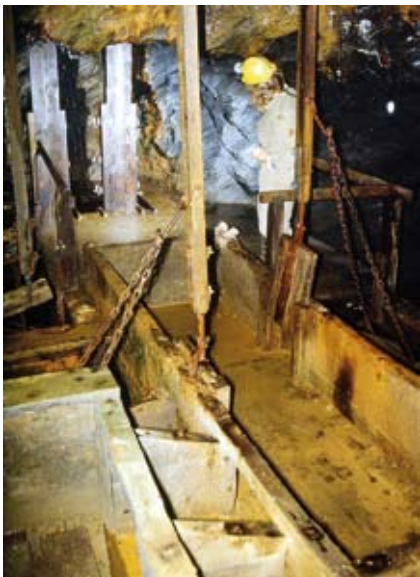
Abb. 4.4.2.c: Wasserkasten in der Serenissimum Kehrradstube. Vorderes Schütz geschlossen. Hinteres Schütz geöffnet.
