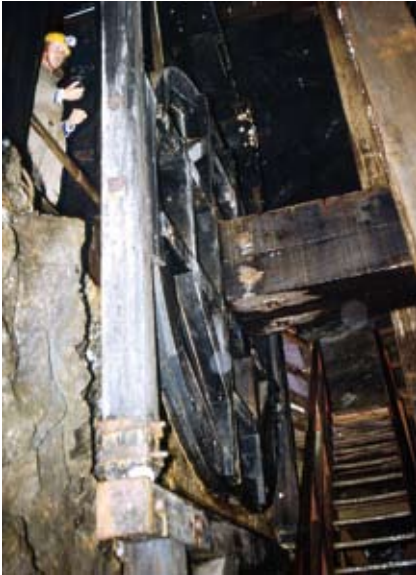
Abb. 4.4.2.f: Bremsrad des Serenissimum Kehrrads. Foto von Holger Lausch
