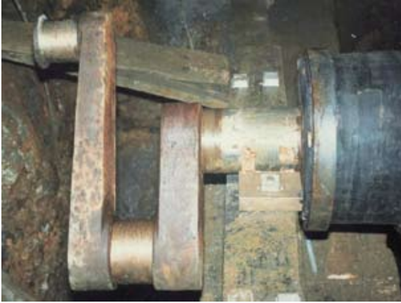
Abb. 3.2.e: Gusseiserne Doppelkurbel des Kanekuhler Kehrrades. Foto von Friedrich Balck
