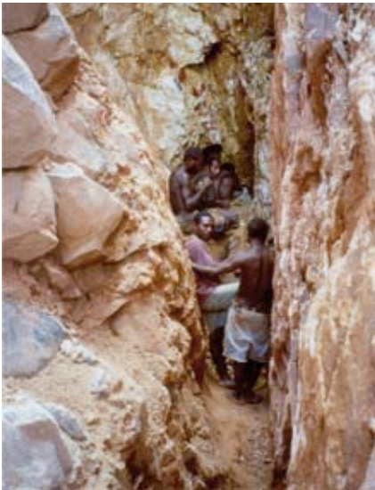
Abb. 2.2.2: Schlitzförmiger mit einfachsten Mitteln angelegter Tagebau am Hang einer Goldlagerstätte in Papua-Neuguinea 2006. Foto vom Verfasser
