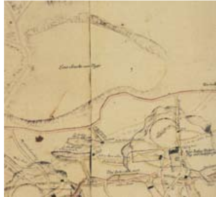
Abb. 1000.3: Ausschnitt aus einem Riss von 1775. Im unteren Bereich sind über- und untertägige Bergwerksanlagen abgebildet. Nördlich davon „Eine Sencke am Tage“ – Reste des ursprünglichen Tagebaus.
