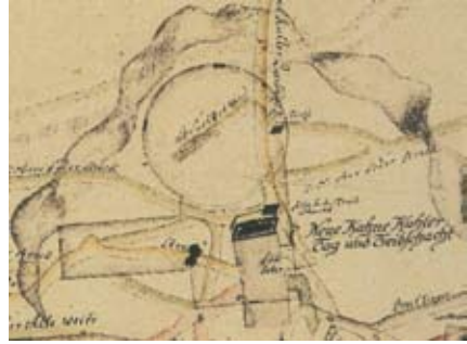
Abb. 1740.4: Kanekuhler Schacht, Ausschnitt aus einem Riss von Johann Heinrich Krauss. 1775 rund: Pferdeumlauf rechteckig: Schachthaus mit Anbau für das angeschlossene Schleppwerk zum Serenissimumum Tiefsten Schacht
