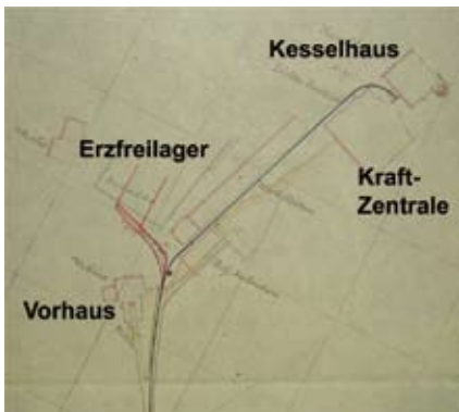
Abb. 1910.3: Tageriss der neuen Gleise. Bergarchiv Clausthal rot: Gleise zum Erzfreilager, blau: Gleis zum Lokschuppen, in dem die Dampfspeicherloks aus dem Kesselhaus übernehmen konnte
