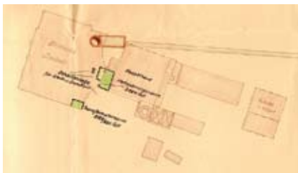
Abb. 1930.3: 1925 nachgerüstete Elektroanlagen. Bergarchiv Clausthal unten mit Kreuzen: die beiden Kohlebunker, darunter das größere Gebäude: Umspannwerk 1, rechts daneben: ein Wohnhaus
