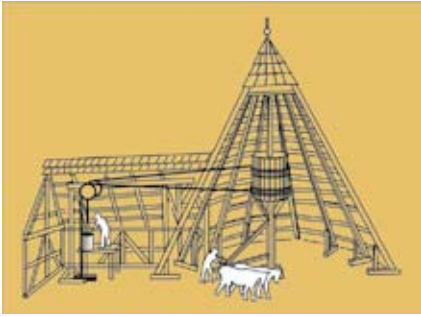
Abb. 1.3.1.8: Skizze Pferdegöpel nach Agricola. Über der Schachtöffnung (links) sind Seilscheiben angeordnet. Der Seilkorb befindet sich auf der Schwankbaumwelle.
