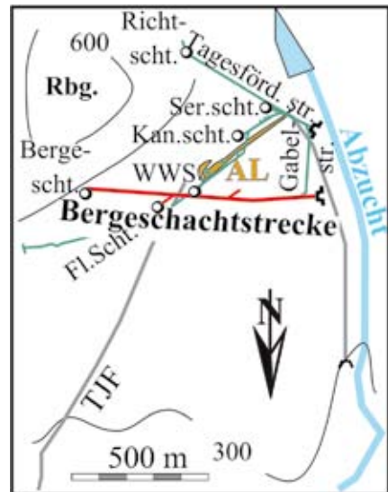
Abb. 40: Bergeschachtstrecke Mitte der 1920er Jahre. Riss-Skizze. Es bedeuten AL: Altes Lager, Bergeschcht.: Bergeschacht, Fl.Scht.: Flacher Schacht, Gabelstr.: Gabelstrecke, Kan.scht.: Kanekuhler Schacht, Rbg.: Rammelsberg, Richt.scht.: Richtschacht, Ser.scht.: Serenissimum Tiefster Schacht, TjF: Tiefer Julius Fortunatusstollen, WWS: Winkler Wetterschacht
