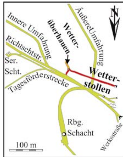
Abb. 137: Wettersonderkreis Altes Lager, Stollen neben der Tagesförderstrecke. Riss-Skizze
