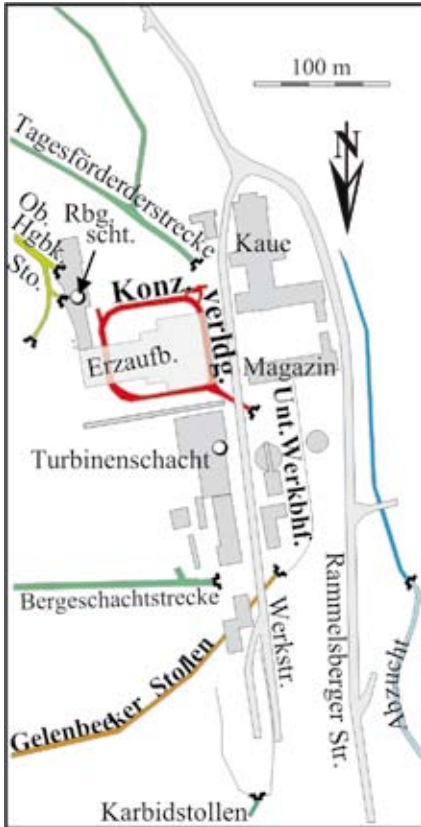
Abb. 68: Konzentratverladung/Untergrundbahnhof unter dem Erzaufbereitungsgebäude. Riss-Skizze
