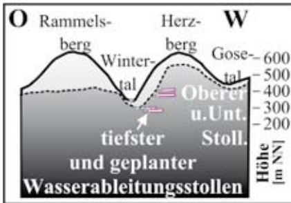
Abb. 131: Grube Weißer Hirsch. Riss- und Schnittskizze. Es bedeuten: Ob.Sto.: Oberer Stollen. Unt.Sto.: Unterer Stollen. Mndl.W.Sto.: Mundloch des unvollendeten Wasserableitungsstollens. projek-tierter Wasserableitungsstollen: Verlauf des ursprünglich geplanten Wasserableitungsstollen
