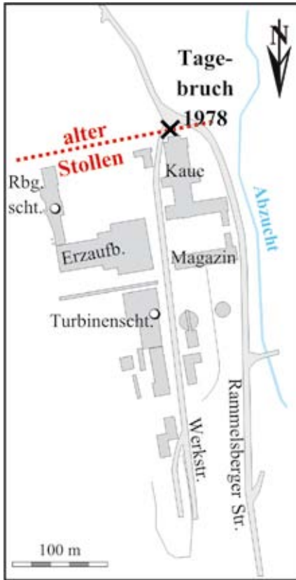
Abb. 28: Ältester Wasserableitungsstollen, Lage des Tagebruchs. Riss-Skizze
