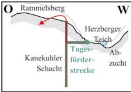
Abb. 14: Vereinfachung der Erzförderung durch Auffahrung des Stollens Tagesförderstrecke. Schnitt-Skizze, rot: Förderung durch die Schächte nach übertage. Beispiel Kanekuhler Schacht, grün: vereinfachte Förderung durch die Tagesförderstrecke
