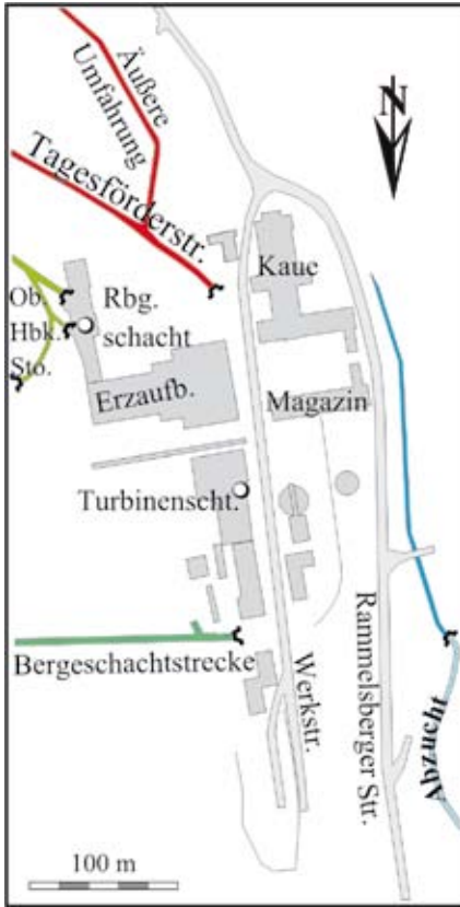
Abb. 104: Tagesförderstrecke (TFS) und Richtschachtstrecke nach 1972. Riss-Skizze
