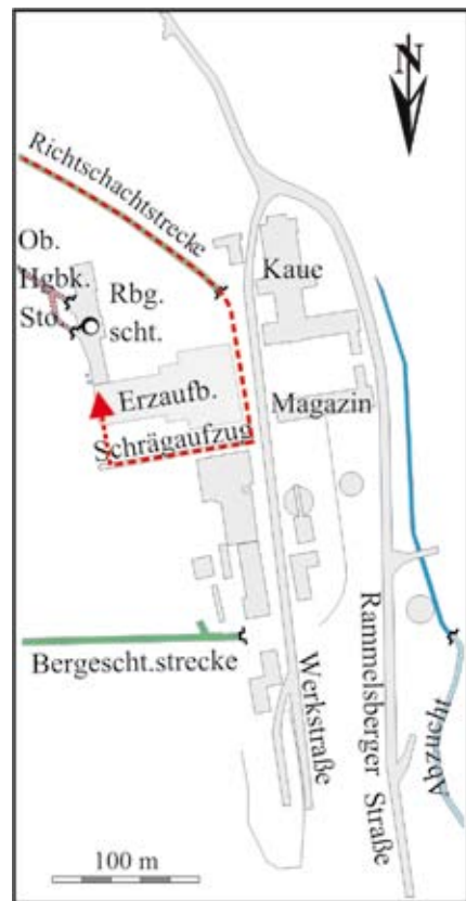
Abb. 77: Oberer Hängebankstollen, Förderung vom Richtschacht durch die Richtschachtstrecke in die neue Aufbereitungsanlage bis 1945. Riss-Skizze
