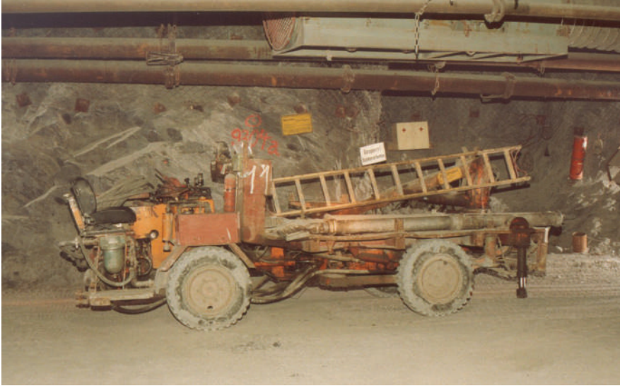
Abbildung 50: SCHELL Servicefahrzeug im Querschlag von der Rampe zur 4. Teilsohle (Foto G. Müller, 1988)
