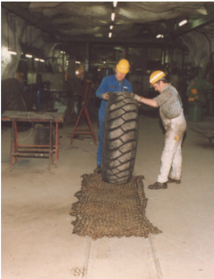
Abbildungen 18 und 19: RUD-Schutzkette. Montage in der EBR-Werkstatt 11. Sohle (Fotos G. Müller, 1988)
