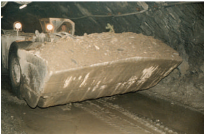
Abbildungen 31 und 32: GHH LF 8 in der Bergeschachtstrecke auf dem Wege zum Rolloch. Hydraulikhammer zum Zerkleinern zu großer Haufwerksstücke über einem Rolloch in der Bergeschachtstrecke (Fotos G. Müller, 1987)
