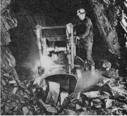
Abbildung 10: gleisgebundener Wurf-schauffellader von ATLAS COPCO LM30 (Werkfoto aus Drucklufthand-buch ATLAS COPCO)
