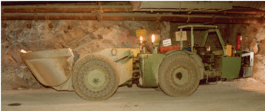
Abbildung 22: EIMCO 912 im Querschlag von der Rampe zur 4. Teilsohle (Foto G. Müller, 1988)
