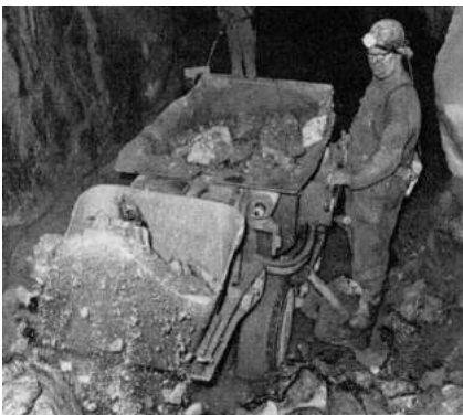
Abbildungen 13 und 14: Foto ATLAS COPCO gleisloser gummibereifter Wurfschaufellader T2GH und Skizze T2GH/T4G (aus Drucklufthandbuch ATLAS COPCO)
