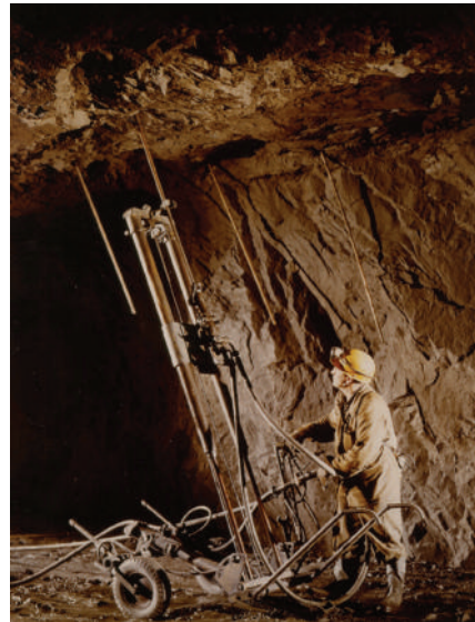
Abbildung 40: Vorläufer der LHD-Technik: Bohrwagen BASK im Kammerbau EBR (Foto aus der Sammlung H. Stöcker)
