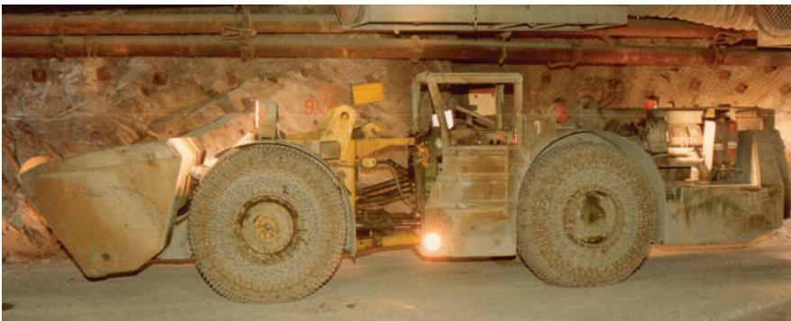
Abbildung 23: EIMCO 913 im Querschlag von der Rampe zur 4. Teilsohle (Foto G. Müller, 1988)
