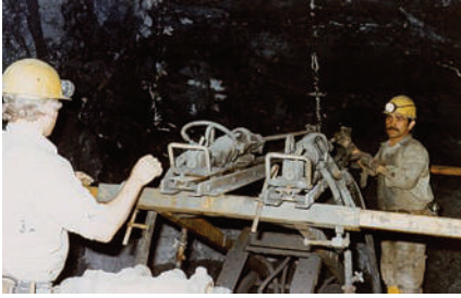
Abbildung 41: Vorläufer der LHD-Technik: ATLAS COPCO-Scherenbohrwagen. In der Bildmitte unten ist der scherenartige Hubmechanismus erkennbar. (Foto H. Stöcker 1978)
