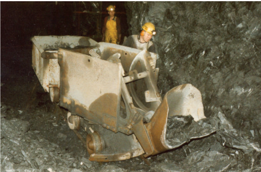
Abbildung 11: gleisgebundener Wurfschauffellader von ATLAS COPCO LM56 mit angehängtem Förderwagen in der 12. Sohle (Foto G. Müller, 1964)
