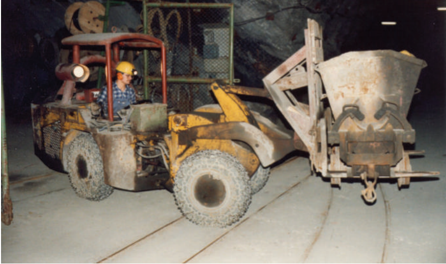
Abbildung 26: EIMCO 911 mit Stapelgabel, 11. Sohle Ausweichlager (Foto G. Müller, 1986)
